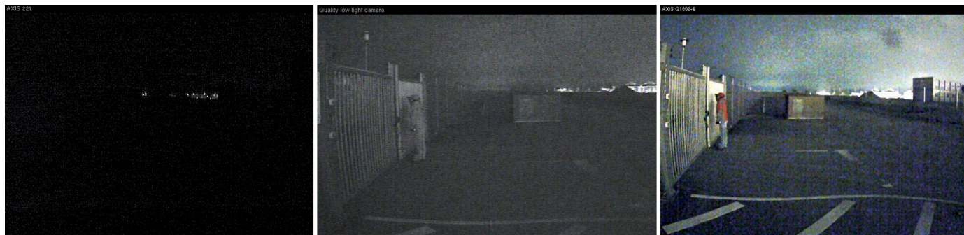
Tecnología Lightfinder en cámaras de red AXIS Q1602/-E, AXIS Q1614/-E Izquierda: Imagen de referencia. Centro: Cámara de vigilancia de gama alta. Derecha: Cámaras de red AXIS Q1602/-E
